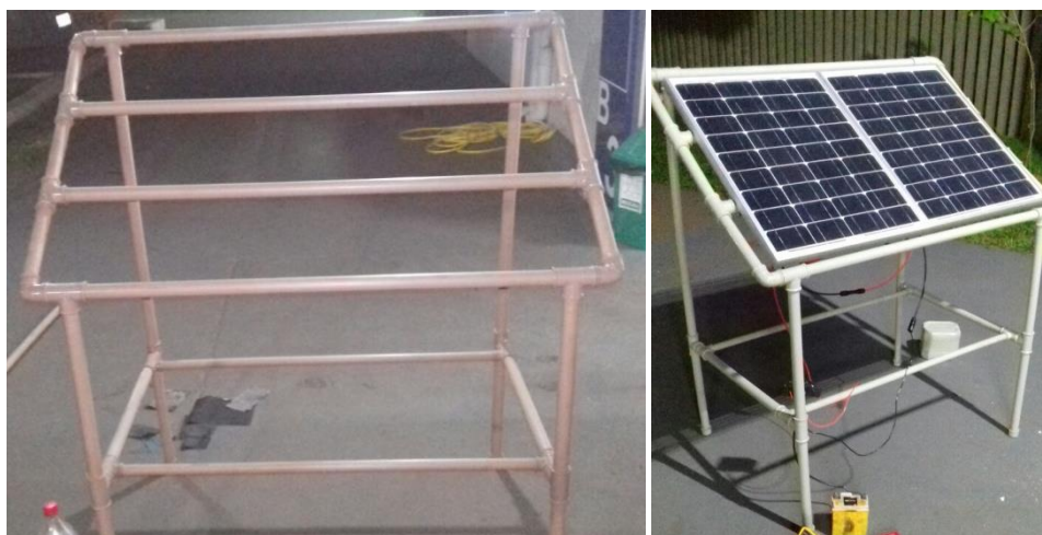
Figura 9. Suporte das placas solares. Foto: ODILON, Celso, 2017
